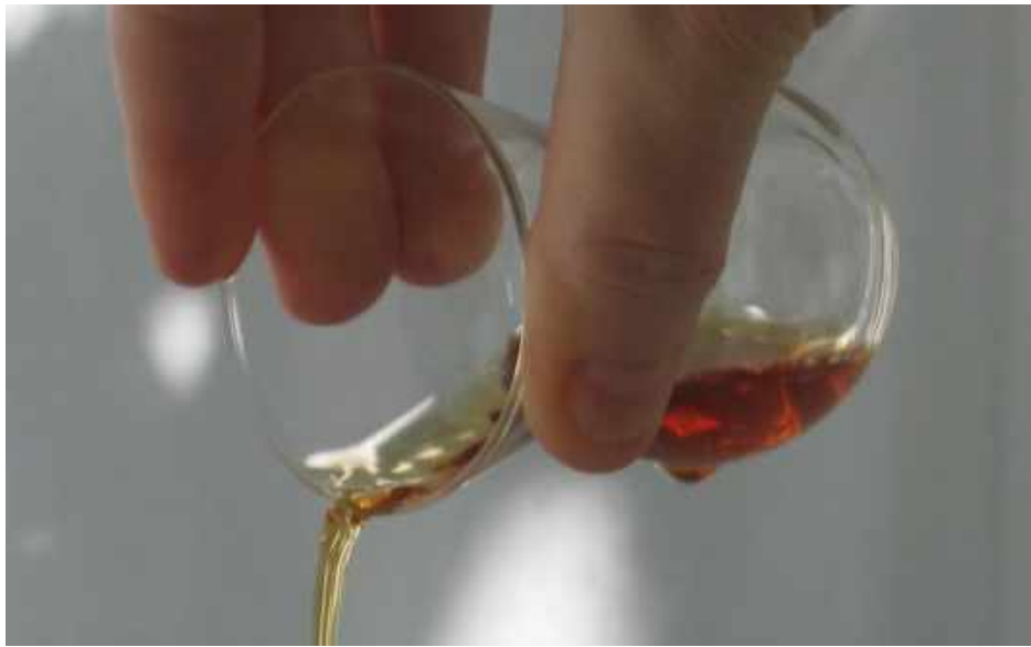
Şekil 29. 'İnce belli' çay bardağının çay akımı üzerindeki hidrolik kontrol rolü.
