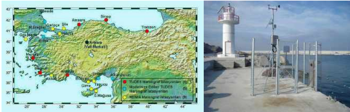
Şekil 32. (a) TUDES – MOMA su seviyesi ve meteoroloji gözlem ağı ve (b) Gökçeada ölçüm istasyonu (Özsoy et al., 2009).
